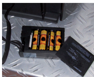
Remplacement des piles du récepteur
