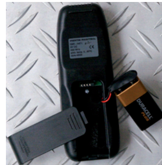
Auswechseln der Batterien in der Fernbedienung
