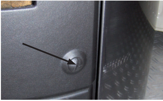
Abschrauben und öffnen der Tür
