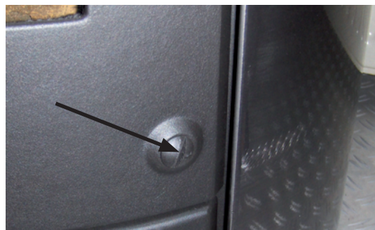
Losschroeven en openen deur
