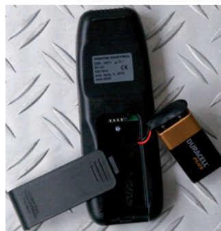
Vervangen van de batterij in de afstandsbediening
