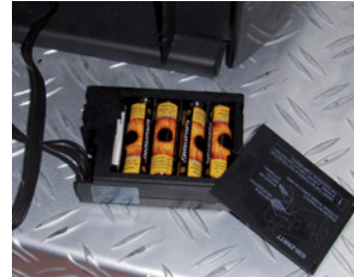
Auswechseln der Batterien im Empfänger
