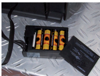
Vervangen van de batterijen van de ontvanger
