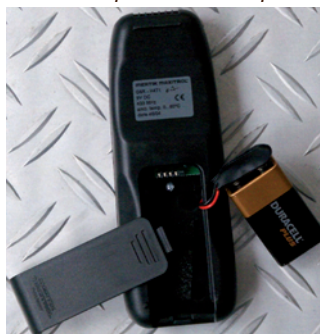
Remplacement du bloc-piles de la télécommande
