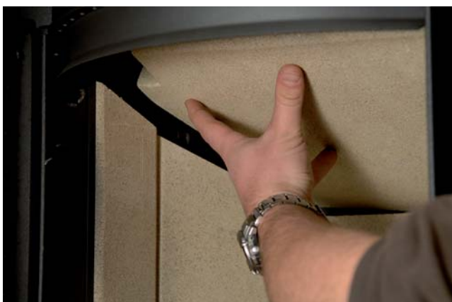
Figure 2 mise en place du déflecteur
