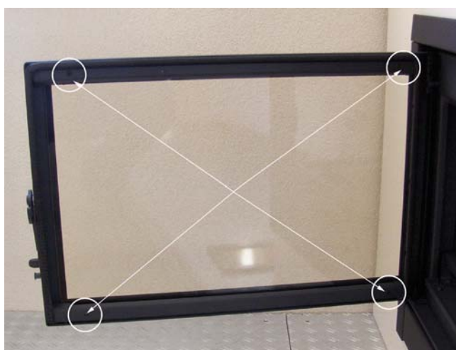
Figure 5: Remplacement de la vitre de la porte
