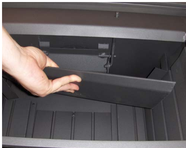
Figur 3 Legen Sie die Rauchgaskehrplatte in den Ofen
