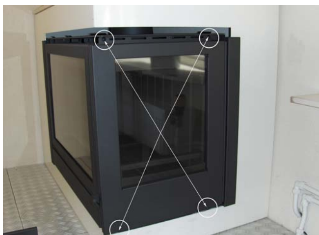
Figuur 6: Vervangen van de zijruit
