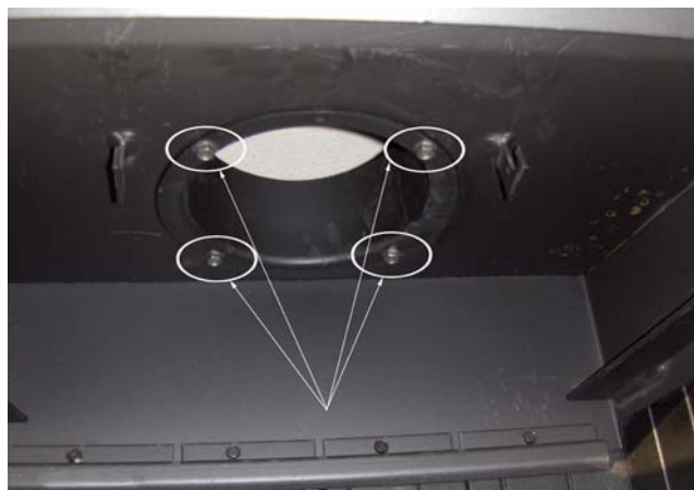
Figur 1 Rohrmund vom Ofen entfernen
